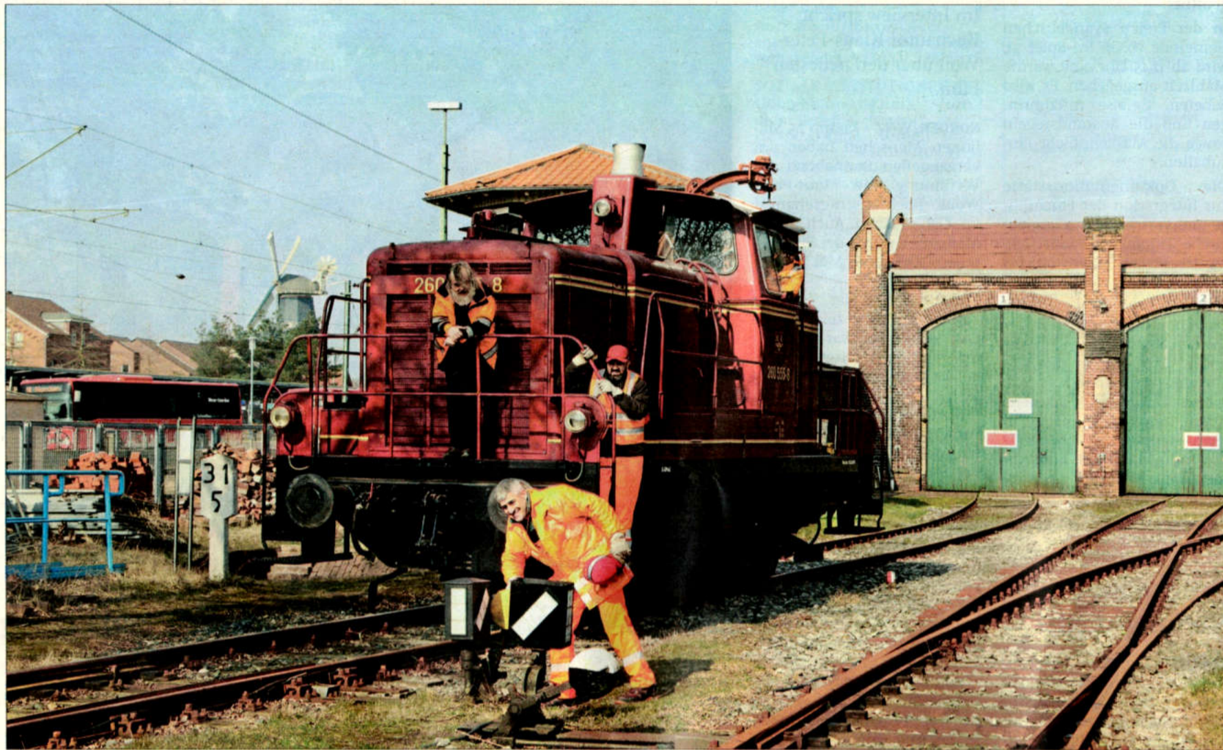
Während MKO-Lokführer Thomas Steinbach die 650 PS starke Rangierlokomotive steuert, üben die beiden Auszubildenden Sunny Hussain (vorn) und Nacmettin Kumru (stehend, rechts) unter den Augen von Ausbilder Mark Pieper (l.) das richtige Umliegen der Weichen.
